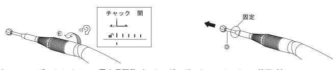
\_**カッティングアクセサリーの露出長調整(スタンダードアタッチメント300使用時)**アタッチメントのツイストコレット®を®の方向に軽く引いて、©、©の方向に回すことでカッティングアクセ サリーの露出長を調整することができます。露出長の調節方法は以下のとおりです。
